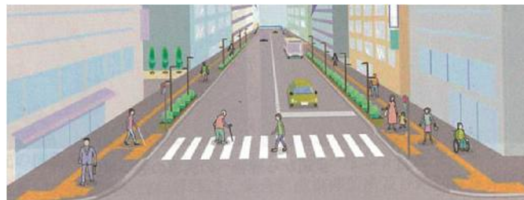
視覚障害者誘導用ブロックの設置
