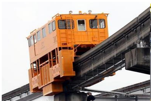
工作車による軌道桁点検
