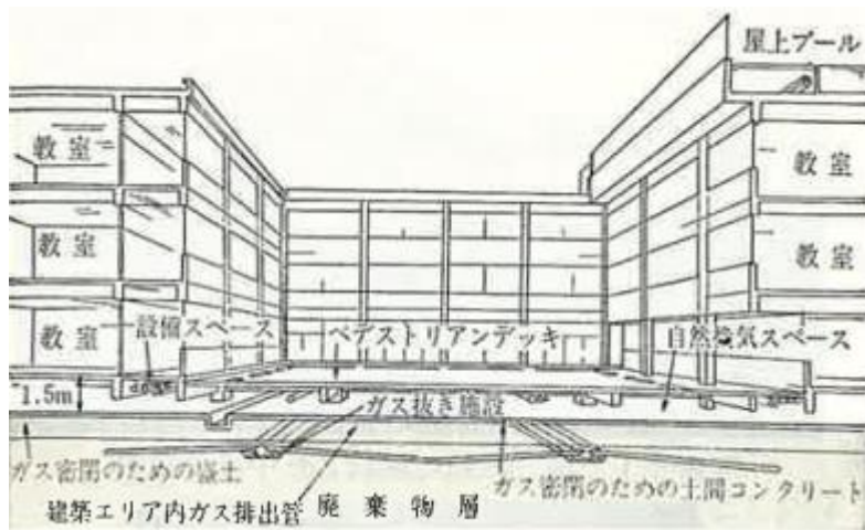
図6 学校建設における対策事例(福岡市)
