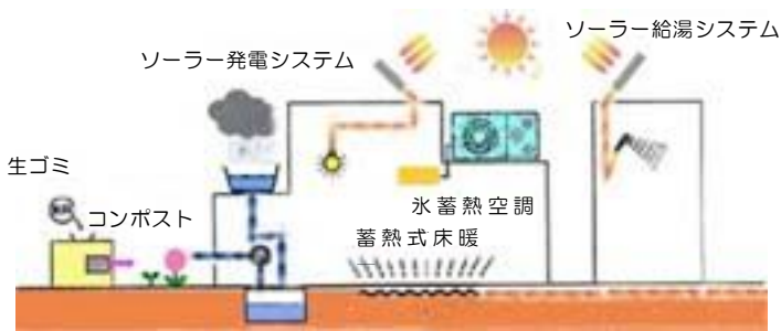
図2.吹田養護学校での環境共生技術の模式図
