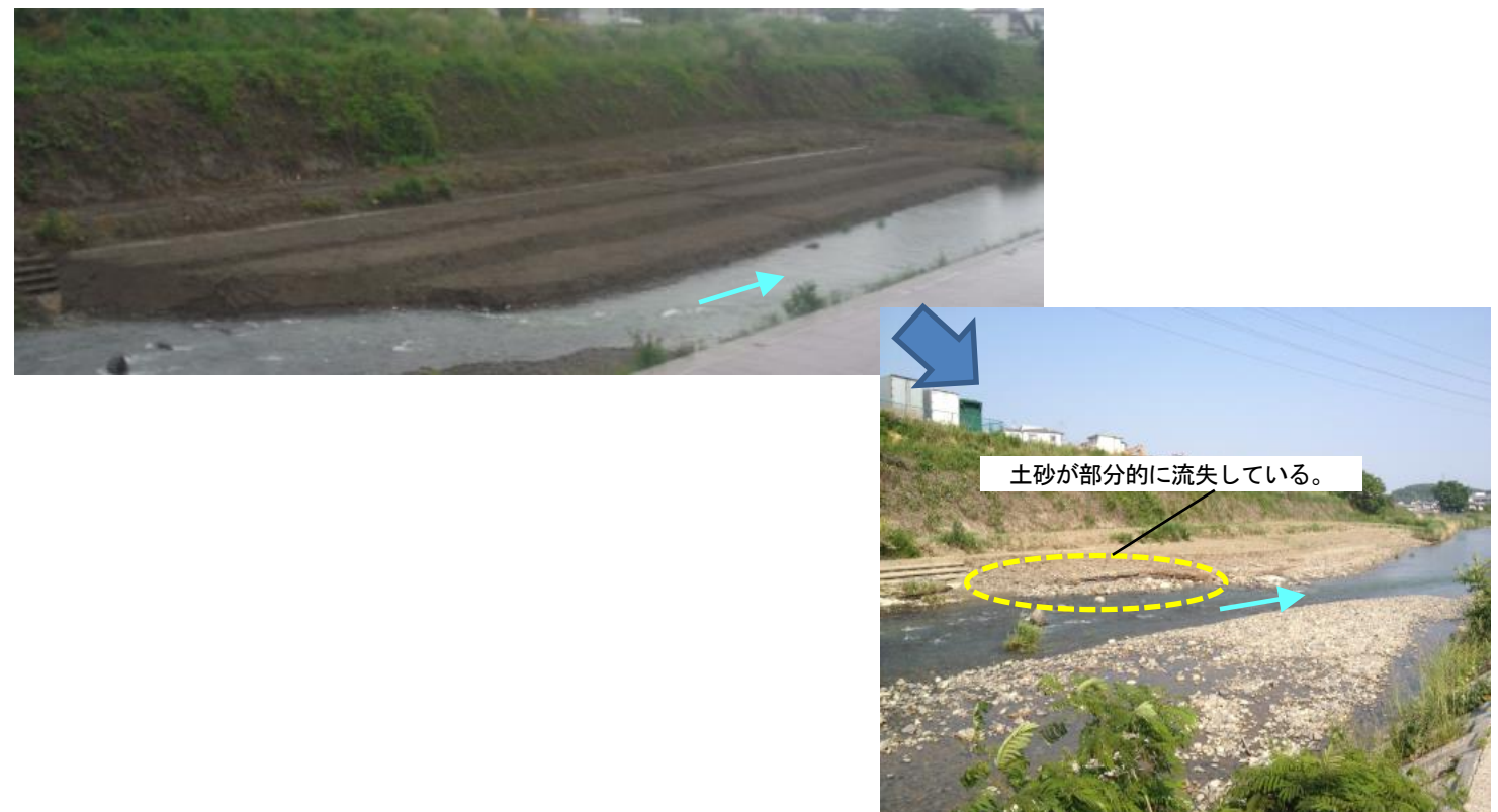
図 5-6 H28.5.16-17 出水前後の置き土試験施工箇所の状況
