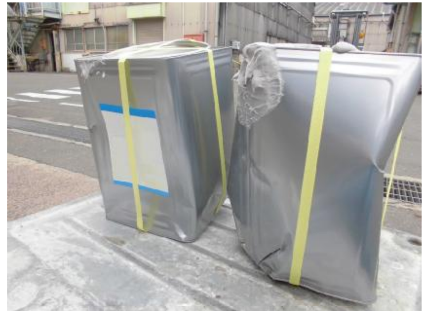
転落により破損した一斗缶
