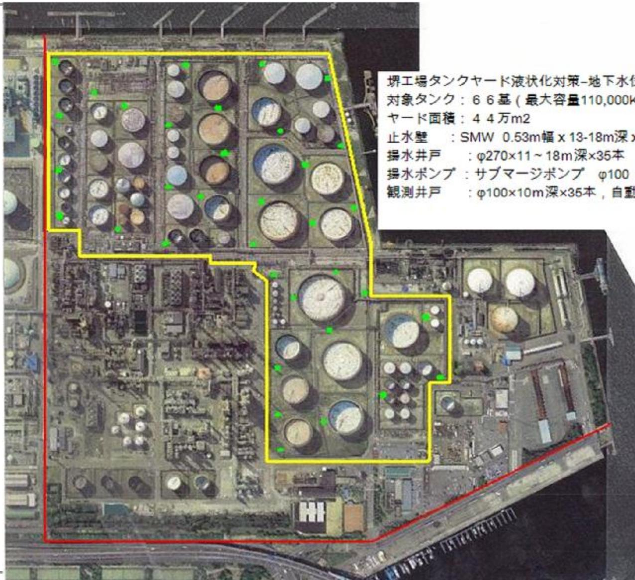
堺工場タンクヤード液状化対策-地下水水位低下設備
