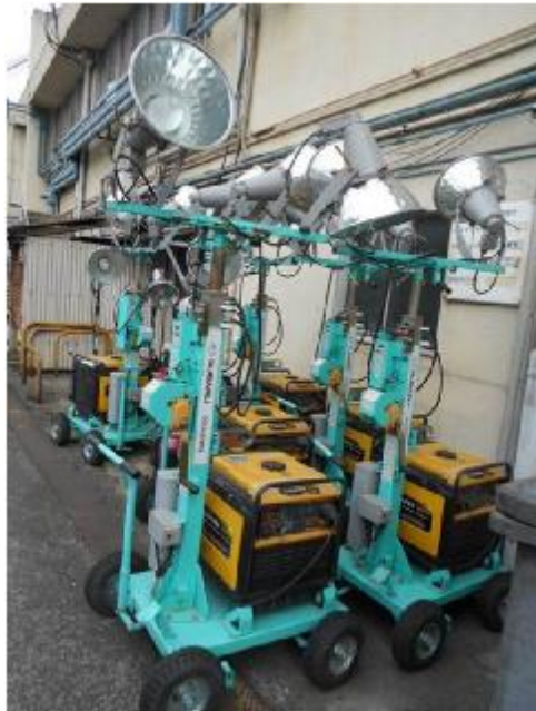
投光機（発電機とセットで現場に持ち運んで使用可能）
