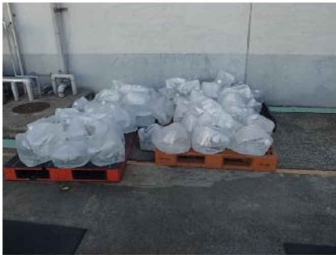
土のう(水を詰めたもの)
