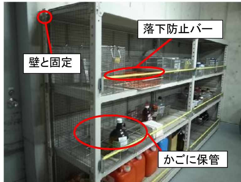
ガロン瓶等の保管棚の転倒・落下防止対策
