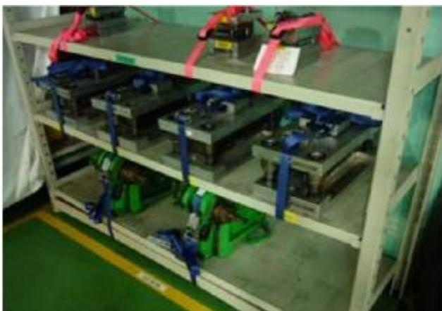
金型のベルトによる固定で落下対策
