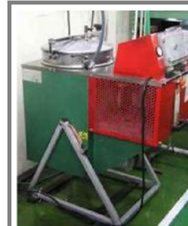
廃溶剤回収装置
