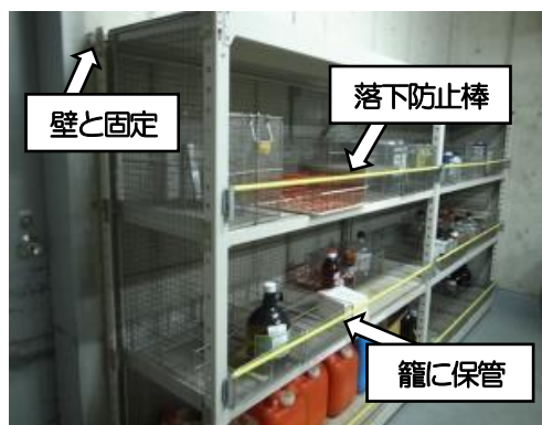
棚と壁との固定、籠での保管等
