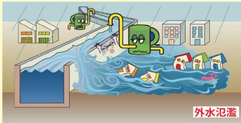
【下水道ポンプ場の運転調整を実施しなかった場合】
