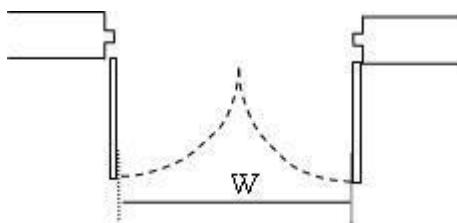
Q5 条例逐条解説P76に、移動等円滑化経路上の出入口においては、戸の前後に150cmの水平なスペースが必要であるとされているが、次のような出入口の場合、図のように開き戸+150cmの水平スペースが必ず必要になりますか。
