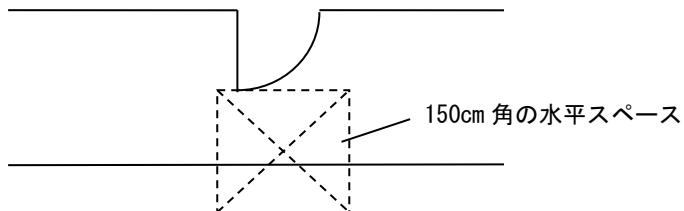
廊下に面する出入口において、スペースの確保が難しい場合に関しては、下図のように、廊下と平行な方向に150cm以上の水平なスペースを確保することでやむを得ないものとします。
