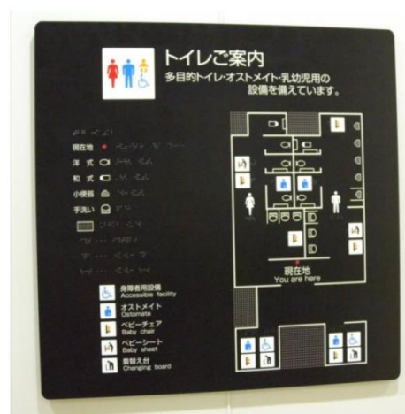
・機能をわかりやすく示し、点字表示・色使いにも配慮された案内表示
