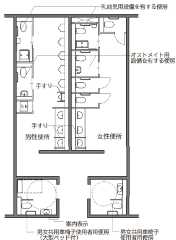
●機能分散の計画例（建築設計標準 P2-114 より）
