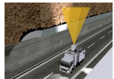
走行型画像計測（トンネル点検）
