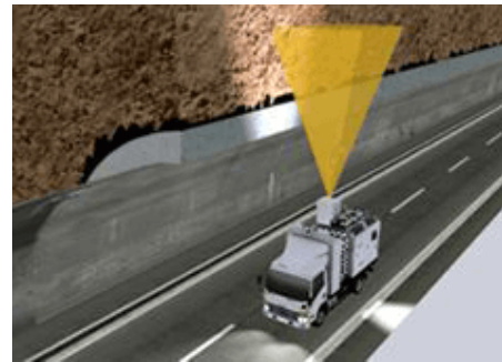
走行型画像計測（トンネル点検）
