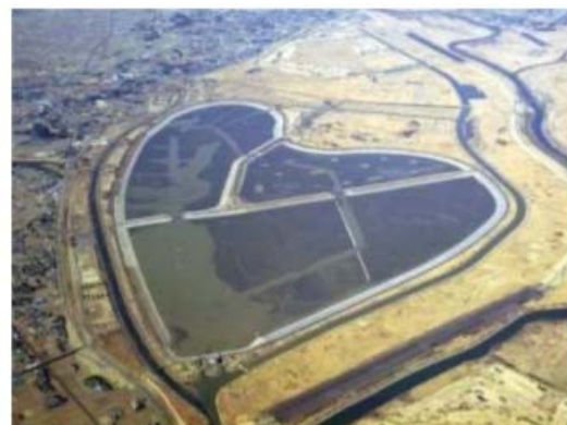
写真 3-2 干し上げ (渡良瀬貯水池) (出典：ダム等管理フォローアップ定期報告書)
