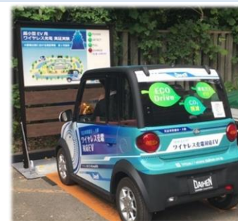
大阪城公園におけるEVの ワイヤレス給電による実証実験
