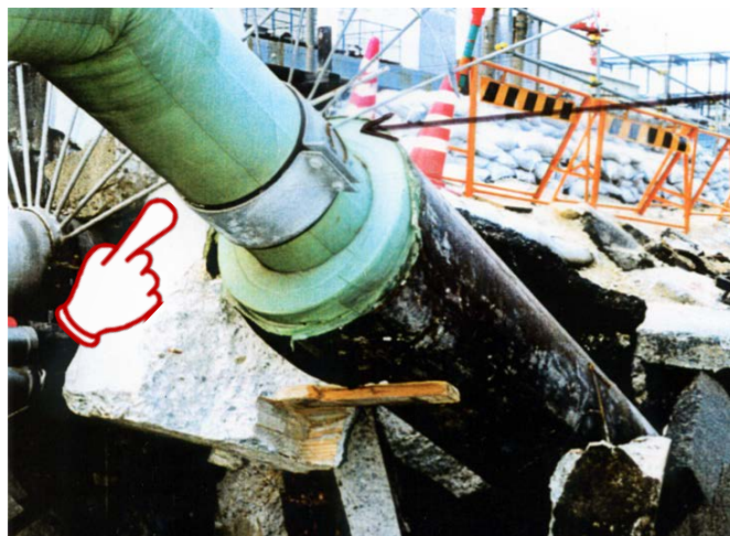
阪神・淡路大震災で落下した橋梁に併設されていた中圧供給管 (当社撮影)
