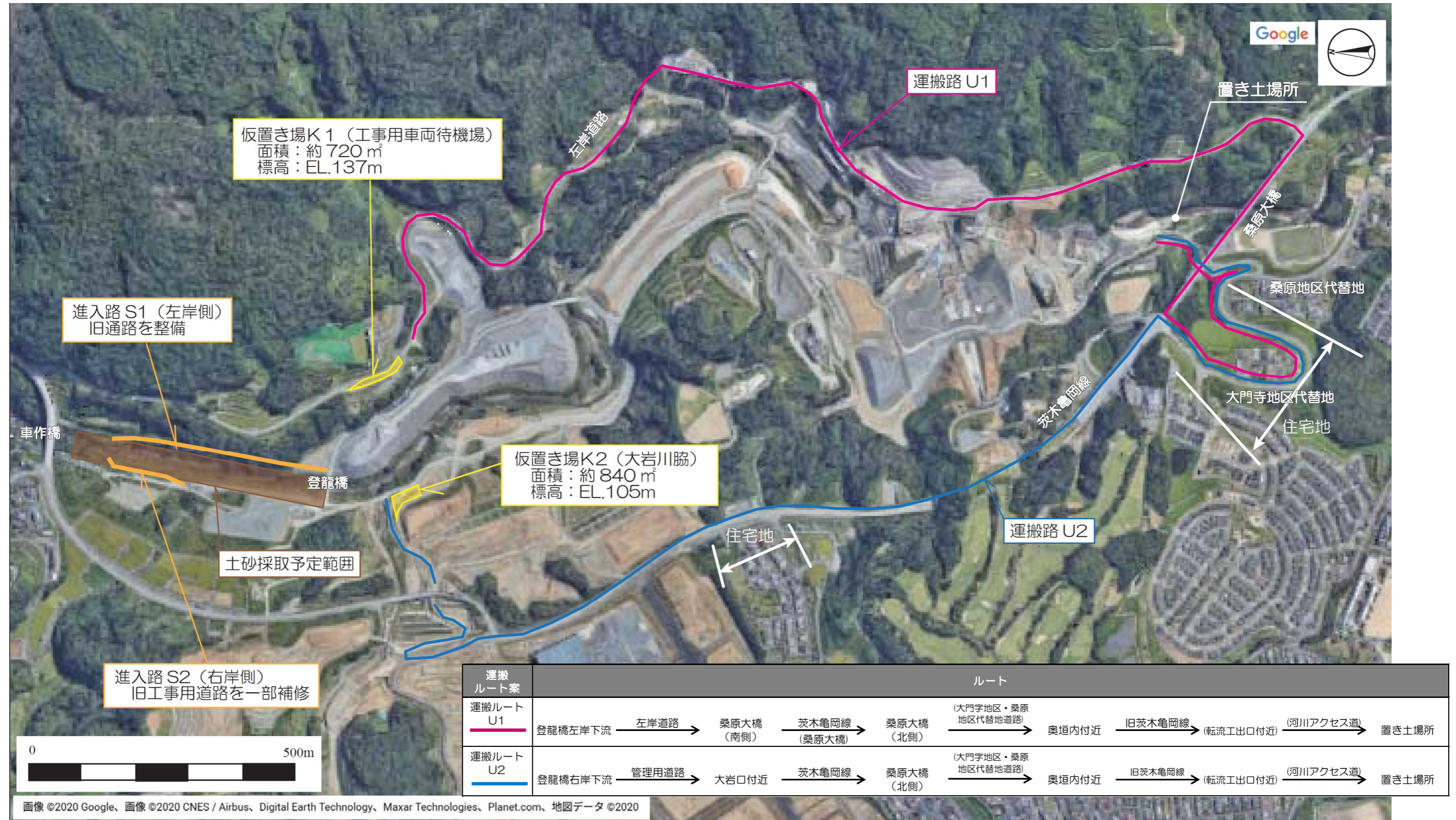
図 3-1 土砂採取・運搬計画総括図
