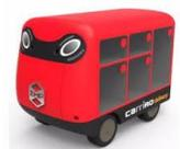
A red, rounded autonomous delivery robot with a white front panel and a camera lens, designed for outdoor delivery of packages.           | GPS等で位置を認識し、地図データに沿って自動走行。車体に取り付けたカメラやセンサーで障害物を検知しながら、指定された場所まで荷物を届ける。 |
