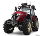
A red tractor with a modern, compact design, equipped with sensors for autonomous operation in agricultural settings.                     | スマート農業の担い手。搭乗状態での自動操舵、有人監視下での自動化・無人化、遠隔監視による完全無人化など技術に段階が存在する。         |
