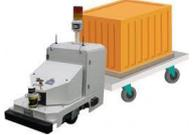
A white autonomous delivery vehicle with a yellow cargo box on top, designed for indoor use in factories or warehouses.                   | 人間が運転操作を行わなくとも自動で走行できる搬送車。主に工場内などを走行。電磁誘導式や光学誘導式などがある。                 |
