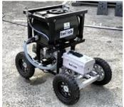
A small, black, four-wheeled autonomous vehicle with a boxy body, used for industrial tasks like spraying or transport in rugged terrain. | GPSを搭載し自動走行する。人間が行うには困難であり、ケガのリスクもある山間部の急傾斜等で農薬噴霧などを行う。                |
