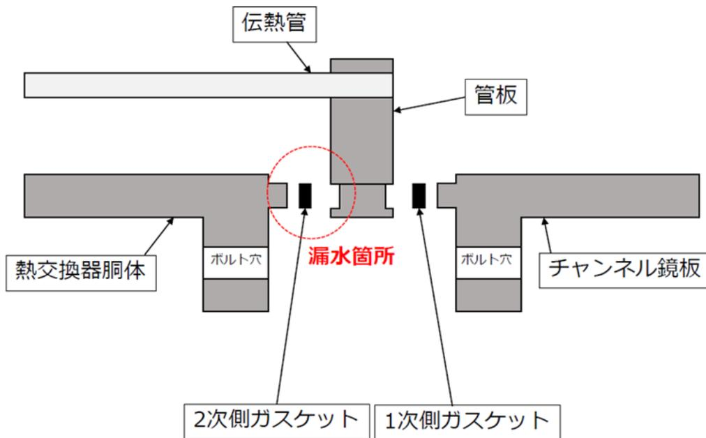
図2 パッキン (ガスケット) の取り付け部の概略図 (漏水箇所拡大図)
