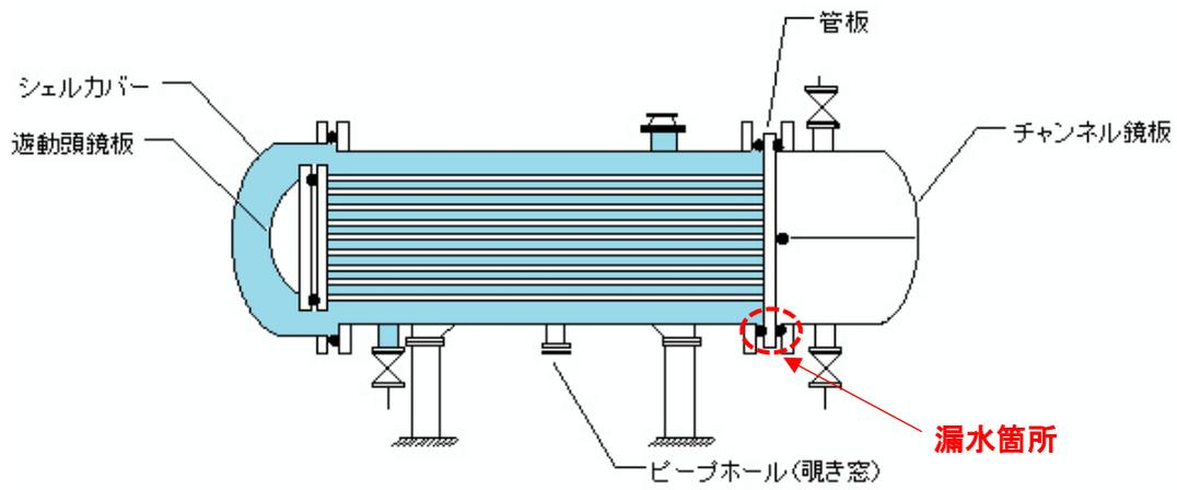
図1 熱交換器断面図 (2次側流路)
