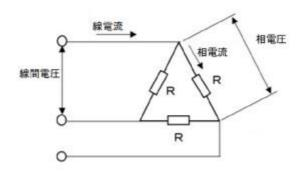
(3) 下図の回路の線電流 I [A]を求めなさい。ただし $\sqrt{3}$  = 1. 7 3 として計算しなさい。また、解答は小数第 3 位を四捨五入し、小数第 2 位まで記入しなさい。
