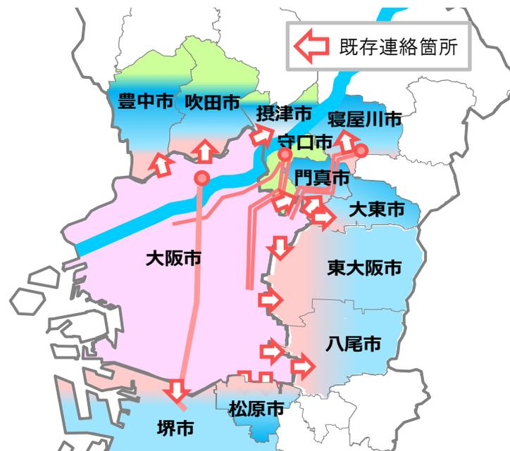
(注) 大阪市と隣接11市は、緊急時用の連絡管等で配水管同士が繋がっており、その連絡管等を活用して、大阪市施設から現行施設能力の範囲で送ると仮定する。
