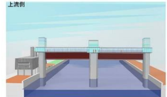
出港時、上流側から見る 二段式ローラーゲートは在揚時の見付け面積が小さく閉塞感の解消が出来ます。
