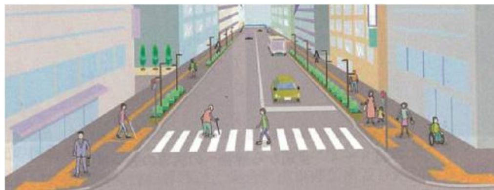
視覚障害者誘導用ブロックの設置
