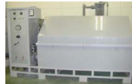
塗装製品の腐食試験 (実製品 (大型))
