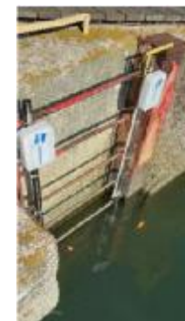
水害時に浸水を検知する 水位センサ
