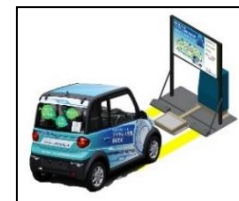
超小型電動モビリティ用ワイヤレス充電システム (イメージ)
