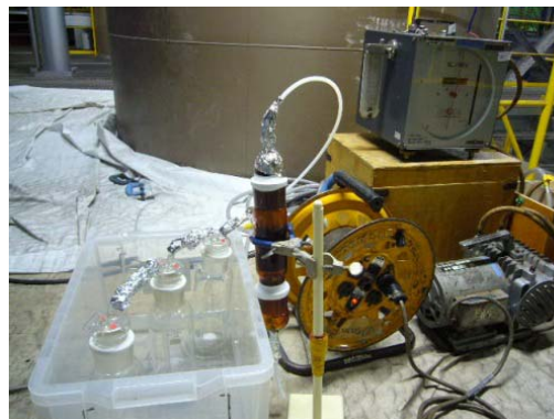
＜ ガス採取装置 ＞ (右上がガス流量計、右下がポンプ)
