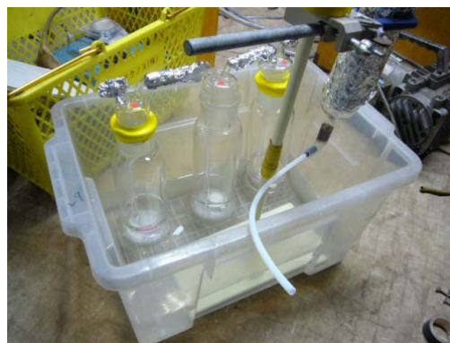
＜ ドレン水と活性炭カラム ＞ (左からドレン水×2、空ビン、活性炭)
