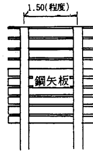
土留柵工の構造の一例 (単位: m)
