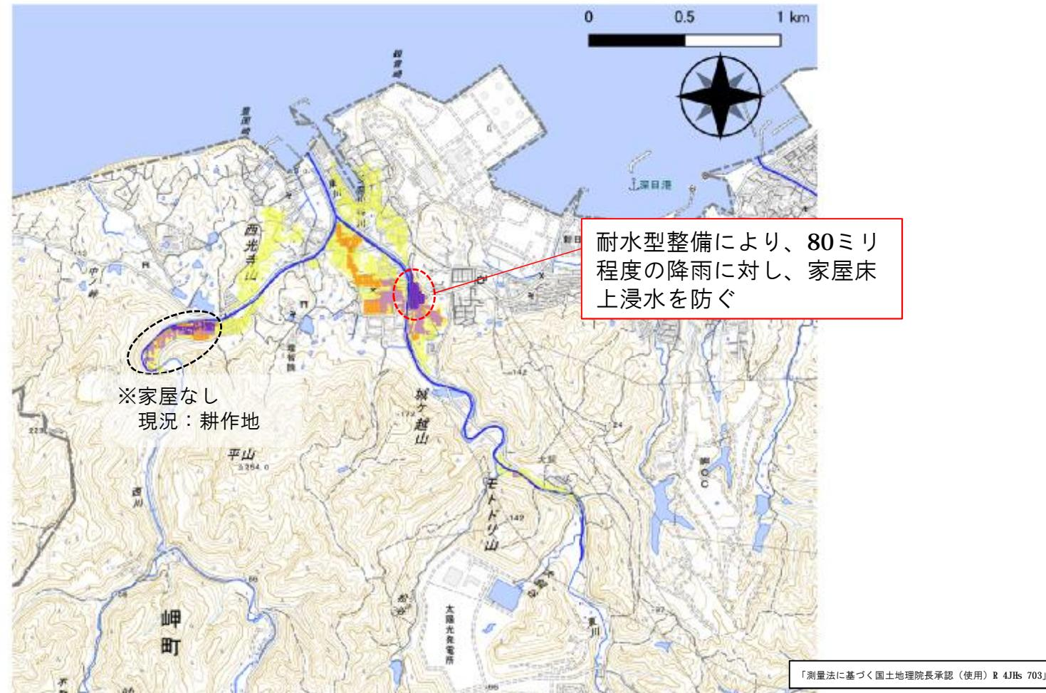
※この図は、氾濫シミュレーション時点（R2）の施設整備状況において、1/10、1/30、1/100の確率年及び想定最大規模の降雨により想定される、府管理河川の外水氾濫の浸水範囲である。
