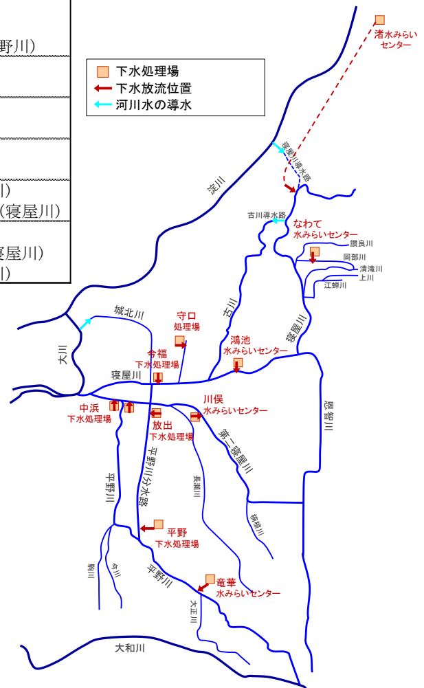
図 5.2 寝屋川流域に放流している下水処理場の位置
