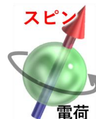
図1 円電流が磁界を作るのと同じように、電荷を帯びた電子の自転は、磁石の源＝スピンとなります。
