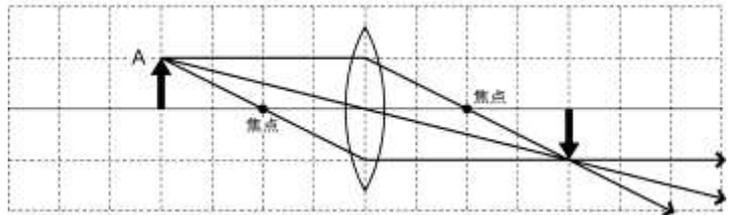
凸レンズの焦点距離の2倍のところに物体を置くと、凸レンズの反対側の焦点距離の2倍のところに物体と同じ大きさの実像ができる。
