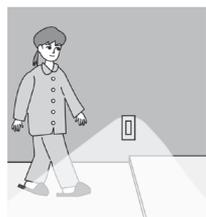
どの強い光を検知しているときは装置が作動しないような工夫や、犬や猫に反応しないように、生き物の高さや幅の違ちがいによって作動するような工夫がなされています。
