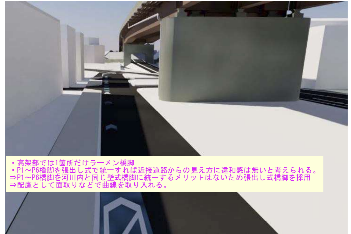
P6 橋脚壁式橋脚(河川内と統一)
