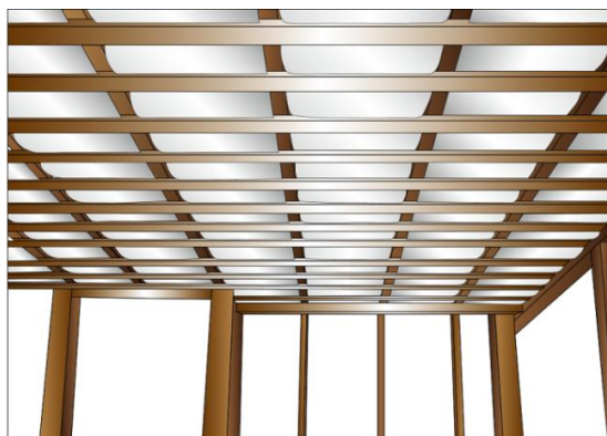
6. 天井(屋根)断熱材 (居間)
