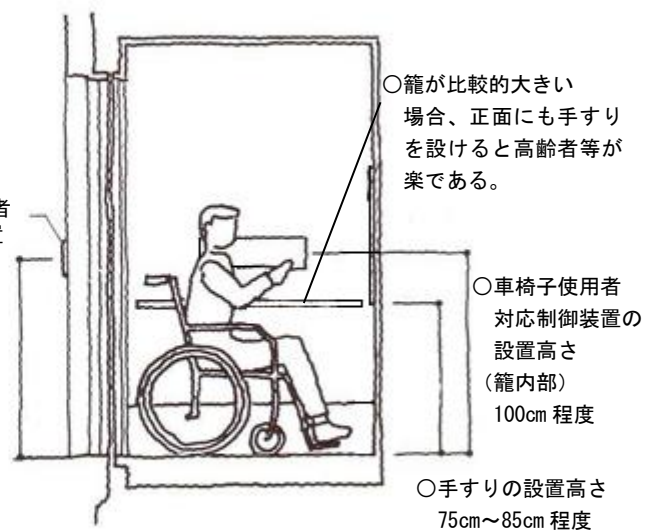
○図 6.4 手すりや制御装置の高さ
