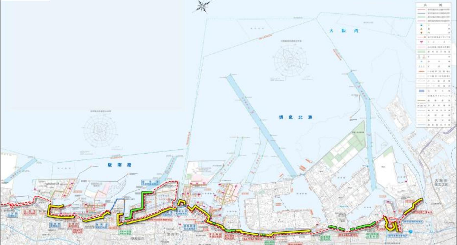
【沈下後堤防高(M9地震による)】
