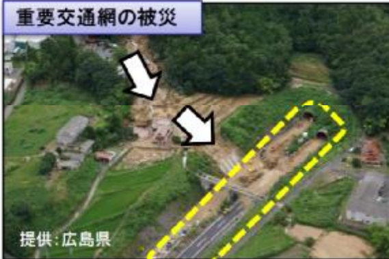
土石流により山陽自動車道が被災(奥谷PA付近)
