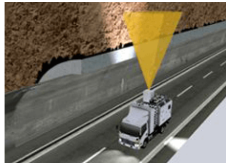
走行型画像計測（トンネル点検）
