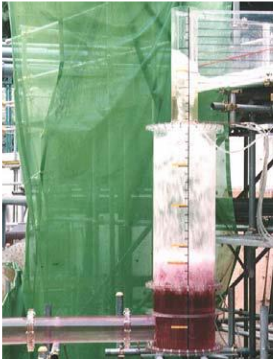
古川取水立坑の実験写真
