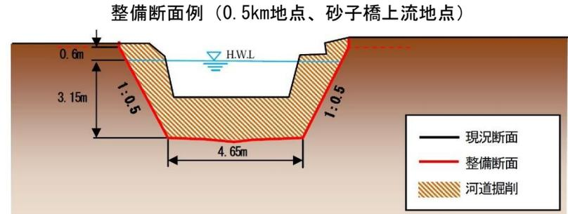
●時間雨量65mm程度の降雨による洪水を対象に整備を行います。
