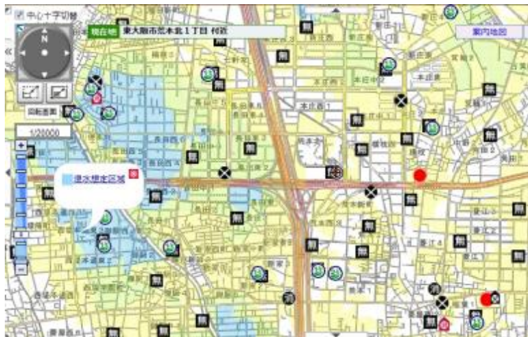
◀河川・下水道を一体解析した氾濫シミュレーションによるハザードマップ事例 (出典：東大阪市)
