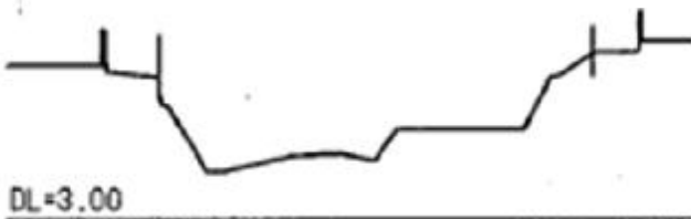
掘込区間 横断面図(南海本線上流)
