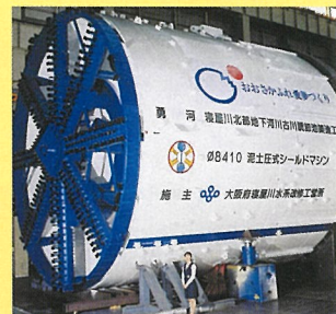
地下河川をほる機械(シールドマシン)
