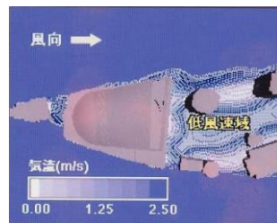
冬期卓越風の風況解析結果(平面)
