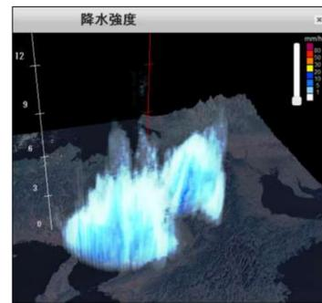
短時間で立体的に観測できるフェーズドアレイレーダをセンターに設置。豪雨の予兆を素早く察知することで処理場の運転を支援しています。
