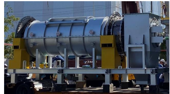
熱分解ガス化改質炉
